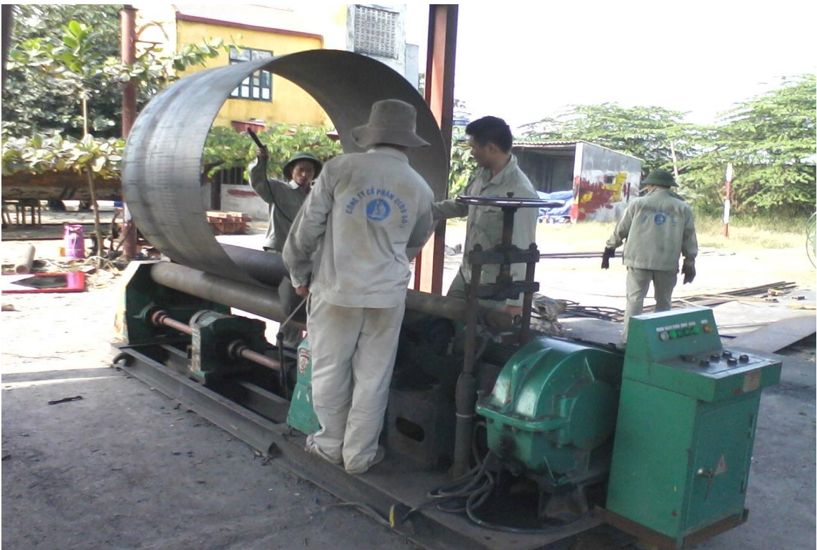
Công nhân của Công ty đang sản xuất phao neo D2.5m – tại Xưởng sửa chữa cơ khí
